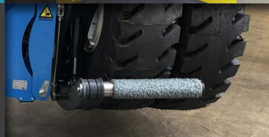
Os tubos revestidos a pedra asseguram uma aderência segura
