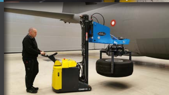
90° de inclinação e rotação +/-25° precisa
