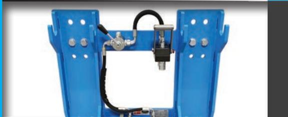
Módulo de Deslocamento Rápido - ligação hidráulica múltipla
