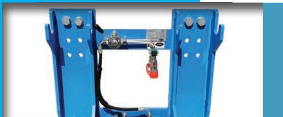
Módulo de Deslocamento Rápido - engate de parafuso
